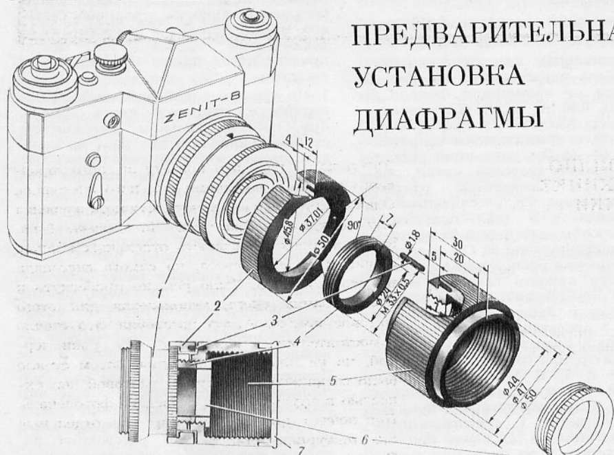
Схема устройства: 1 — объектив; 2 — установочное кольцо; 3 — штифт; 4 — опорное кольцо; 5 — кольцо-бленда; 6 — светофильтр; 7 — крышка
